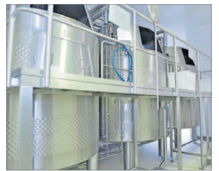
Zeitenwechsel: Im klimatisierten Raum mit den drei gewaltigen, offenen Gärtanks herrscht sterile Reinraumatmosphäre.
