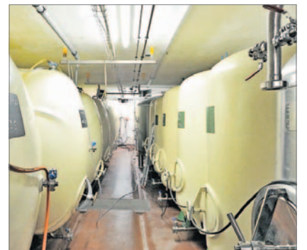
Frostig geht es auch im Lagerkeller zu: In bis zu 19 Tanks unterschiedlichen Alters lagern die sechs Bierspezialitäten vier bis sechs Wochen.
